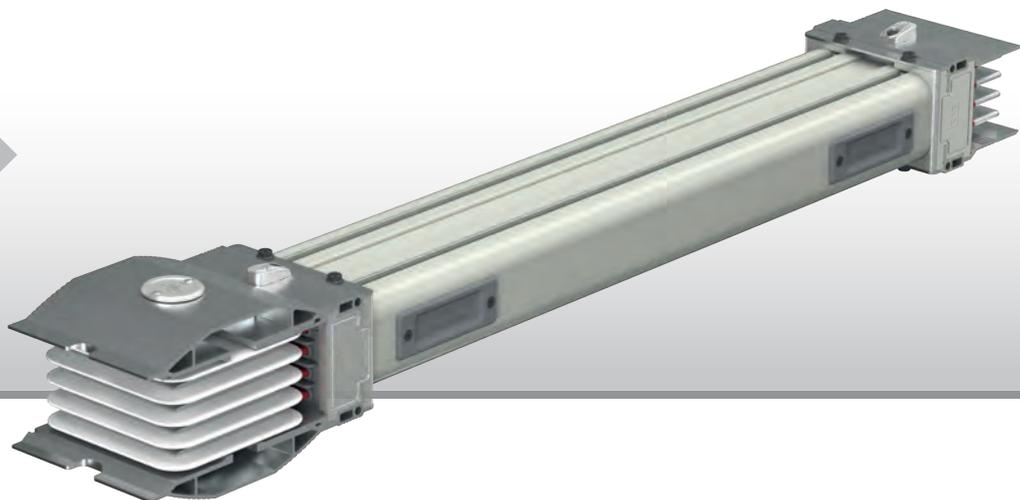
D'une capacité nominale comprise entre 600 A et 6 300 A, accueillant des conducteurs haute conductivité en cuivre ou en aluminium, les gaines à barres E-Line CCR se distinguent par leur enveloppe en DURACOMP, matériau composite alliant résine époxy et silicium pur, dont l'insertion dans un boîtier en aluminium procure un indice de protection IP68 contre les environnements sévères, conjuguée à une bonne résistance au feu, à l'humidité et à un niveau élevé de défaillances.
