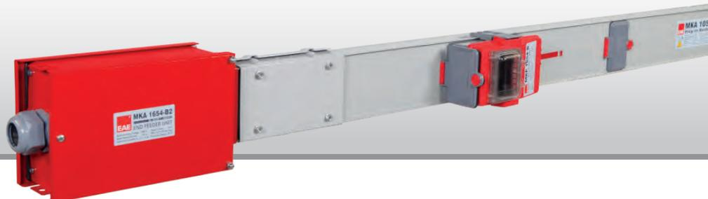
La présence de points de dérivation tous les 50 cm de chaque côté des gaines à barres de la série E-Line MK permet de disposer d'un point de dérivation tous les 25 cm sur les unités de cette série. Utilisable dans les applications tant horizontales que verticales, ce modèle propose pour solutions de dérivation des boîtiers en métal ou en plastique (jusqu'à 80 A dans le second cas) facilement personnalisables en fonction des besoins de protection électrique ou de comptage d'énergie.
