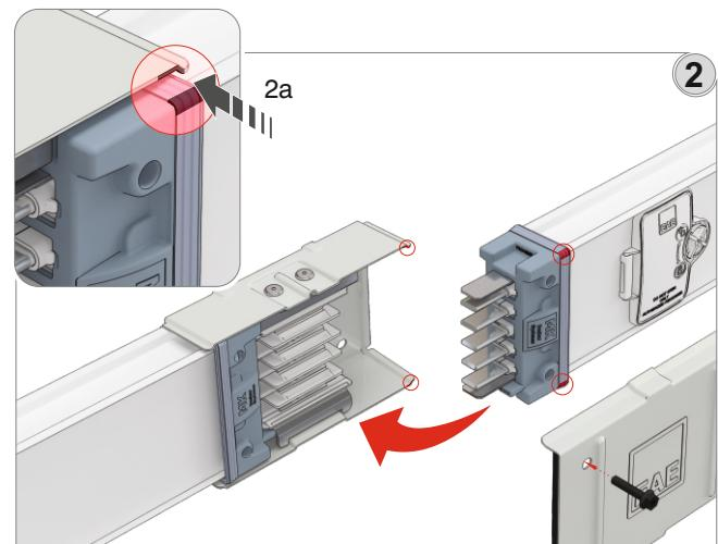
Blok eksiz kanalı, blok ekli kanala monte ediniz. (2a)
